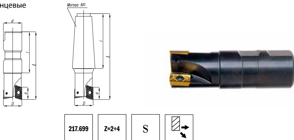
z chwytem walcowym ze spłaszczeniem / with Weldon shank / Zylinderschaft mit Mitnahmefläche / хвостовик Weldon
